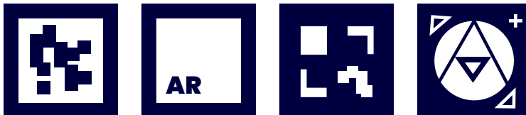
Abb. 04: Typische Marker für markerbasiertes Tracking
